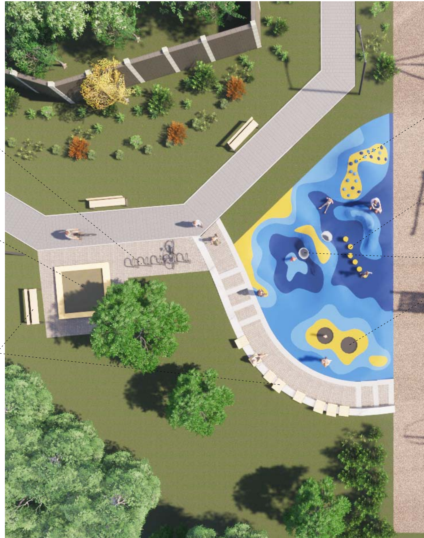
POHLEDOVÝ BETON - sedací zídka s lavičkami, výška 400mm, šířka 400mm
