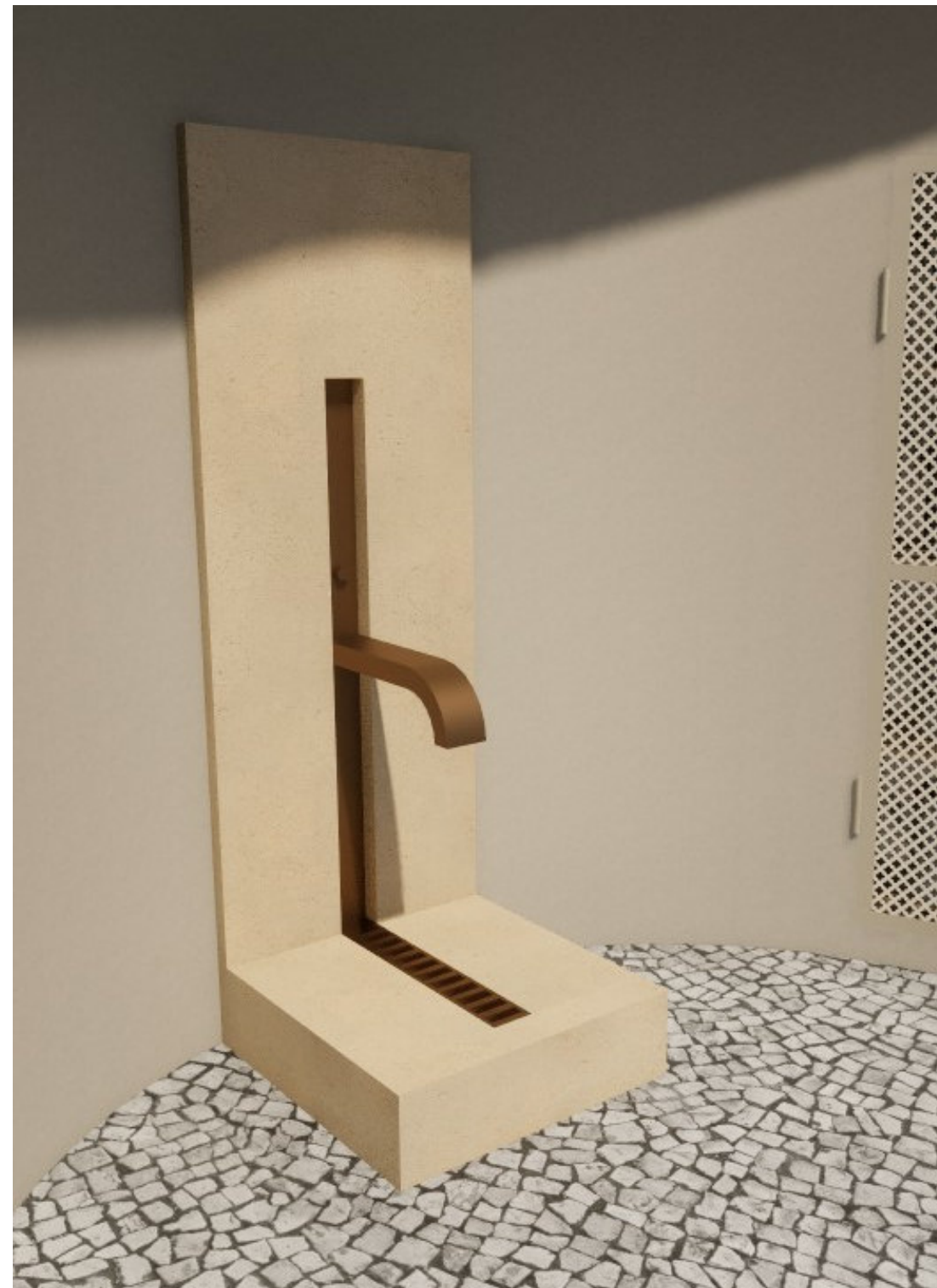
KÁMEN Na spodní část a záda bude použit světlý kámen. Např. pískovec.
